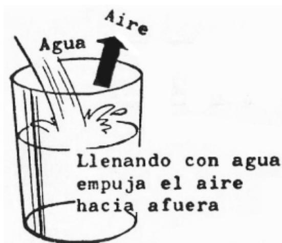
Como el sistema por chorro de aire emplea el aire para dar cobertura, es importante comprender especialmente que: PARA OBTENER UN BUEN TRABAJO DE PULVERIZACION QUE CUBRA TODAS LAS PARTES DEL ARBOL, EL AIRE QUE SE ENCUENTRA DENTRO DEL FOLLAJE DEL ARBOL DEBE SER REEMPLAZADO POR AIRE SATURADO CON LA MEZCLA QUIMICA.
